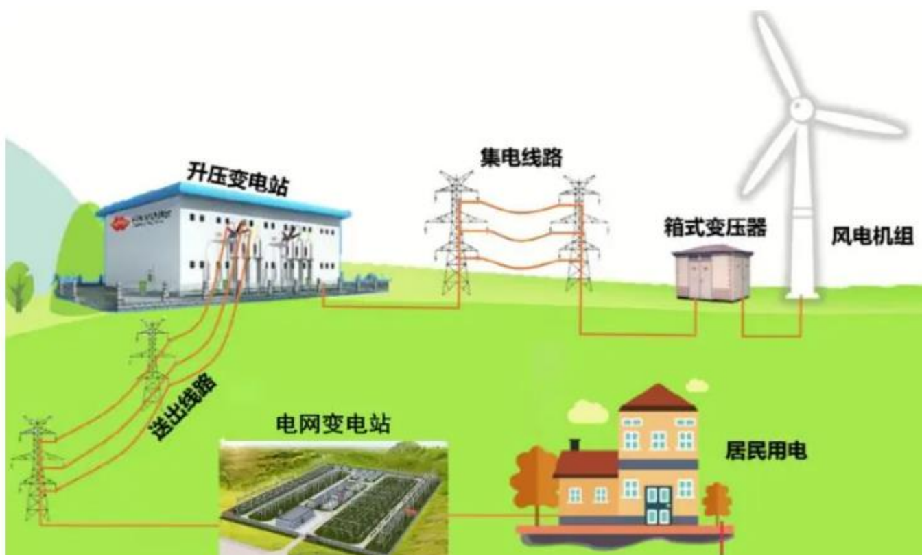
风力发电从发电到用户的全过程图解
