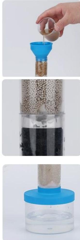
2.将泥水慢慢从上倒入塑料试管内。干净的水渐渐在底下的罐内积存。泥水之所以变得清澈，是因为花岗岩石子、瓷沙等起到的过滤作用。（过滤干净的水请勿饮用!）
